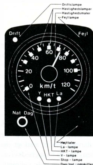
Fig. 3. Førerrumssignal med hastighedsmåler.
